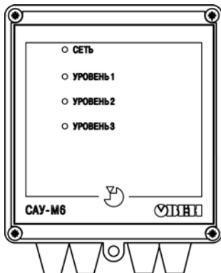
Рисунок 6.3 – Лицевая панель прибора
